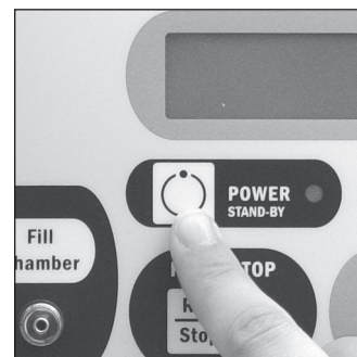
Pulsar el botón de alimentación Power. El LCD se iluminará.
