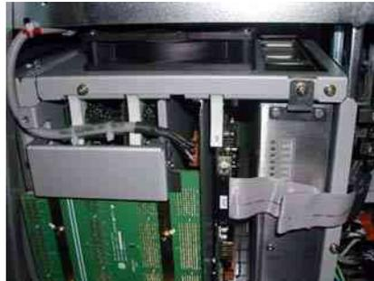
(d) Cooling FAN Assy for NEST Cooling
