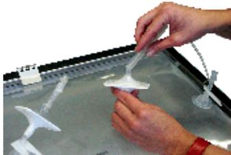
1. Schließen Sie den Anschluss „Gas 1 bzw. Gas 2“ des BIOSTAT® RM 20 | 50 basic an das sterile Zuluftfilter auf dem CultiBag RM mit Hilfe des mitgelieferten Schlauchs an. (Das Zuluftfilter ist das Filter ohne Überdruckventil). Werden zwei CultiBags RM benutzt, verwenden Sie beide Ausgänge des Rockers.
