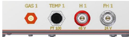
Abb. 2: Schematische Darstellung der linken Seite BIOSTAT RM
