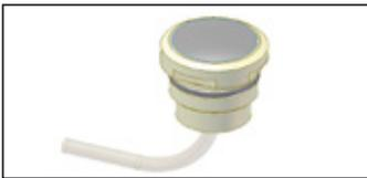
Das dreiphasige Widerstandsthermometer Pt100 der Klasse A (EN60751) misst die Temperatur vom CultiBag RM. Das Thermometer samt Kabel wird durch die Aussparung in dem Bag-Halter 20 | 50 geführt und anschliessen mit einer Steckverbindung mit dem Rocker 20 | 50 verbunden. Der Kopf wird mittels O-Ring in der Aussparung fixiert. Anschluss: Geräteseitig Temp 1 und Temp 2, Schutzart: IP67
