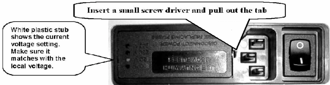
Figure 3.7. AC inlet on CEU.
