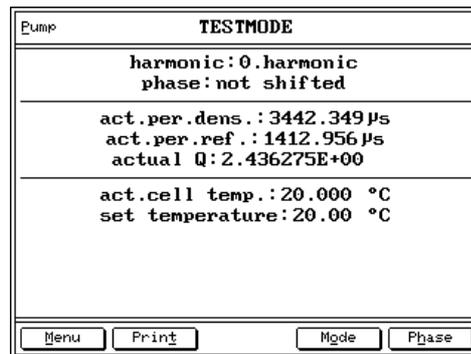
Fig. 11 - 4 Screen: Testmode
