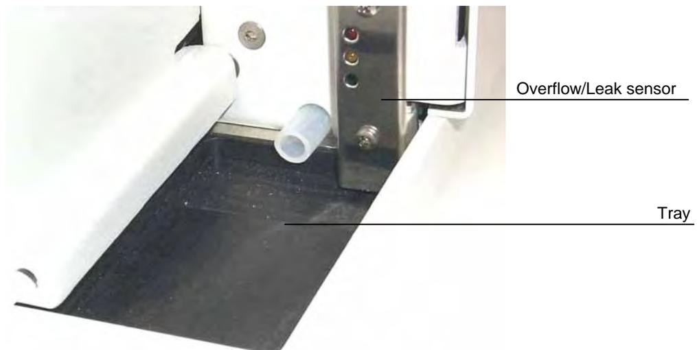
*Fig. 33: Overflow/Leak sensor*
