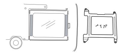
b. Remove the display module.
